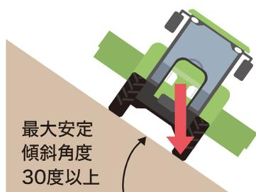
※車両総重量が車両重量の1.2倍を超え、かつ積載により重心高さが上がるものは最大安定傾斜角度35度以上
