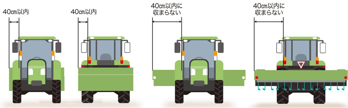
■道路運送車両法の保安基準により、各種灯火器類の取付け位置は以下のように定められています。
