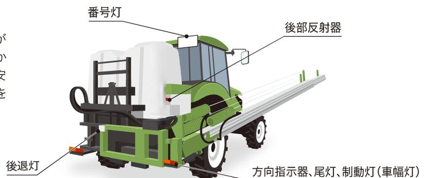
※回転灯が備えつけられている場合、結線を外したり覆いを被せるだけでなく、道路走行時は必ず取り外してください。
