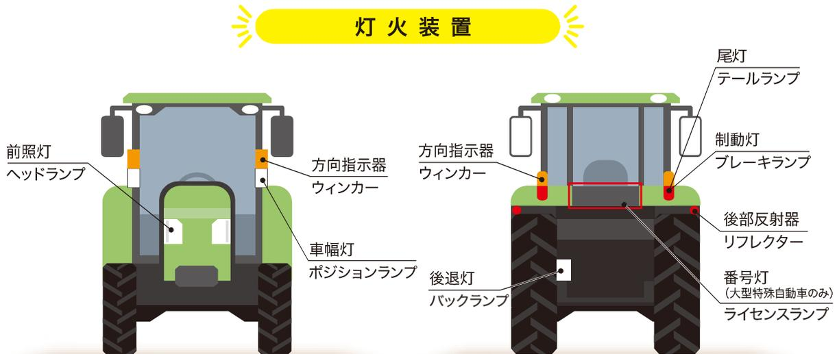
灯火装置、反射器の位置はトラクタのメーカー、シリーズ、型式により異なります。
